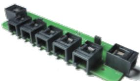
Ich habe einen RJ12-Verteiler gebaut, der optional auch die zwei Dioden für das Pseudo-GND (siehe [RSCLD](#)) und einen Widerstand wie [hier](#) enthält. Das Pseudo-GND kann über eine Steckbrücke zugeschaltet werden. Den dort enthaltenen Widerstand habe ich derzeit nicht bestückt. Ein bestückter Widerstand kann bei Bedarf mit einem Jumper überbrückt werden. Das Pseudo-GND darf nur einmal in einem RailSync-Versorgungsabschnitt vorhanden sein.
