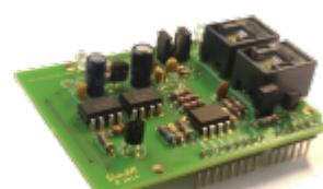
Signalführung zum Arduino ist wie beim [FremoLNShield](#) ausgeführt, so dass für Tx das Signal D6 oder D7 verwendet werden kann. Eine weitere LED kann optional für weitere Signalisierungen genutzt werden, diese ist aktuell nicht bestückt.
