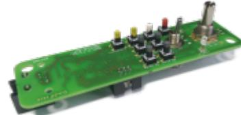
Die hier vorgestellte Version der Leiterplatte hat als 3,3V-Regler den **LP2951-33D** im Design, der für niedriges ESR geeignet ist. Es kann auch der dreipinnige **LP 2950 ACZ3,3** auf die Pads gelötet werden, wie bereits bei der oben dargestellten 1.8C-Variante. Ein nicht mit Lötstopplack abgedeckter Teil eines Leiterzuges dient als Pad für dessen mittleres GND-Pin.
