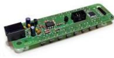
Bei der Inbetriebnahme habe ich festgestellt, dass im Sketch nicht alle Funktionen der PIC-Vers-148 umgesetzt wurden, wie sie im [GCA123/GCA50](#) verwendet werden. Als Input ist nur die Variante „Block Sensor“ umgesetzt. Eine Option, die auch in der Sensor-Funktion fehlte, habe ich nachträglich in den Sketch eingefügt. Das ist die Option „Active High“, die ich für die [Weichensteuerung](#) mit Rocrail nutze. Für meine Anwendung sind beide LocoIO-Keypad-Varianten jetzt gleichwertig.
