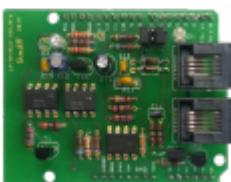
Für Experimente mit dem Arduino und den von [MRRWA](#) veröffentlichten Bibliotheken und Beispiel-Sketchen habe ich den LocoNet-Teil der Schaltung des oben beschriebenen LocoBuffer-II+USB auf eine Arduino-Shield-Platine gebracht. Die Versorgung der LocoNet-Seite erfolgt aus dem RailSync. Die 15mA-LocoNet-Stromquelle (Pull Up) ist über eine Steckbrücke aktivierbar. Die
