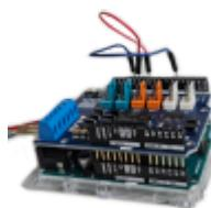
Auf Basis des Arduino Uno wurde eine Command Station aufgebaut. Dazu wird zusätzlich ein [MotorShield](#) benötigt. Die [Verdratung](#) und die [Einbindung](#) ist bei rocrail beschrieben. Für die Software habe ich die Beispielprogramme [BaseStation-Classic](#) von DCC-EX und die [Ursprungsversion](#) von DCCpp getestet. Die zugehörige Bibliothek [DCCpp](#) kann über die Arduino-IDE eingebunden werden.
