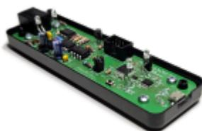
Aus der Zusammenführung des Schaltungsdesigns des [LNShield-ISO](#) bzw. Loconet-USB, dem Arduino-Pro-Mini und einem USB-Seriell-Wandler wurde der LocoBuffer-ProMini entwickelt. Die Baugruppe realisiert über die Optokoppler eine galvanische Trennung zwischen PC und Loconet wie bereits beim LocoBuffer-USB. Wie beim LNShield ist Tx auf D6 oder D7 über Jumper oder Drahtbrücke konfigurierbar. Rx liegt auf D8. Die **15mA-LocoNet-Stromquelle** (Pull Up) ist über Jumper **JP4** aktivierbar.
