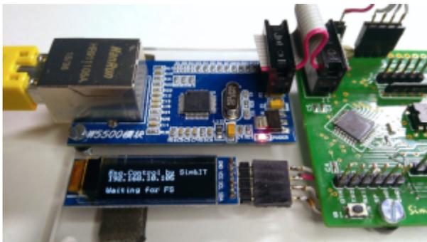
Die Anzeige ist ein OLED-Display mit einer Auflösung von 128x32 Pixeln, welches über 4 Leitungen als I<sup>2</sup>C-Gerät angeschlossen wurde. Der Display-Controller ist ein SSD1306. Wegen der geringen Größe des Speichers des Arduino wurde eine sehr einfache Bibliothek eingebunden. Diese ist in der Arduino-IDE mit **ss\_oled** bezeichnet.
