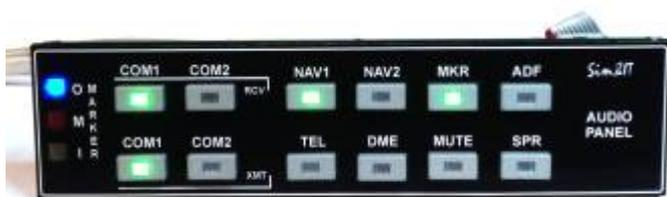
Das Audio-Panel ist von der Anordnung der Tasten in grober Anlehnung an das KMA-30 gestaltet. Das Panel wird über Ethernet mit dem FS-PC verbunden. Der Arduino-Sketch verarbeitet die Taster-Ereignisse, die über UDP (Ethernet) zu einer Schnittstellensoftware auf dem PC übertragen werden, der hieraus FS-Kommandos generiert. Die aktualisierten Variablen werden an das Audio-Panel übertragen und mit LED-Anzeigen
